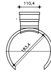
7 SELIM 90° - SOLDÁVEL ESCALA 1/20 ( PARA TUBOS COM DN ≥ 200 )
