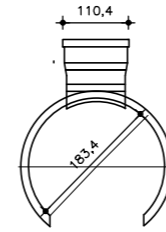
7 SELIM 90° - SOLDÁVEL ESCALA 1/20 ( PARA TUBOS COM DN ≥ 200 )
